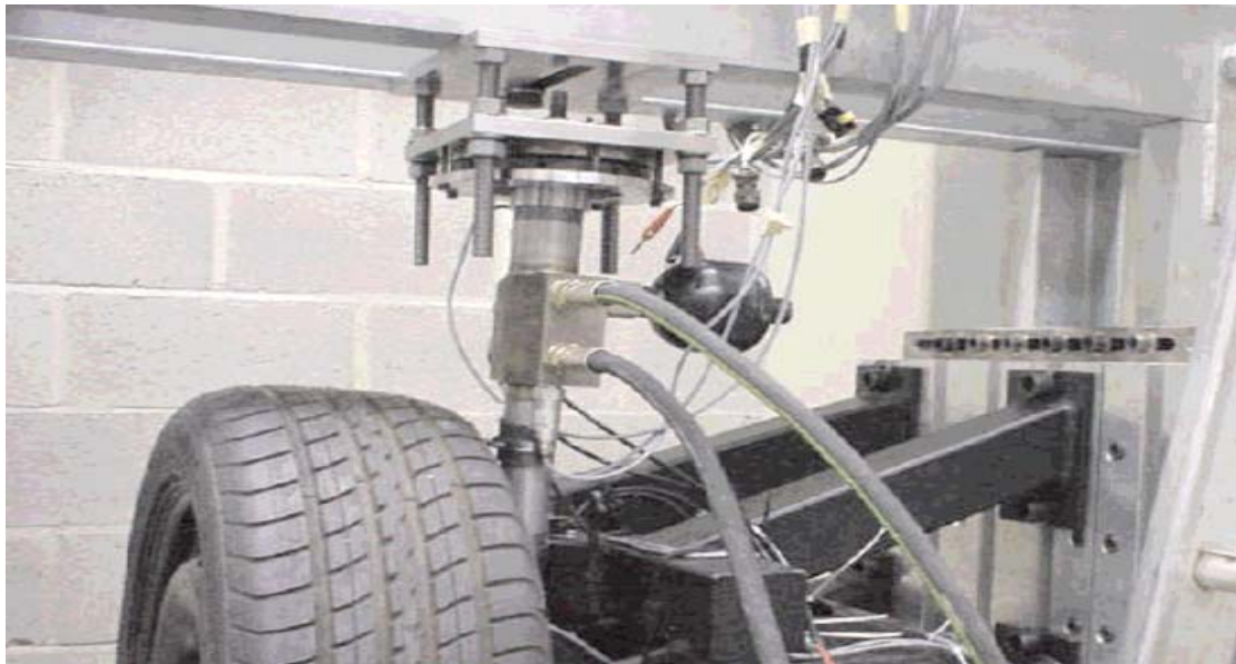
Figura 3. Stand de probă pentru testarea suspensiei de tip sfert de mașină (1/4M)
