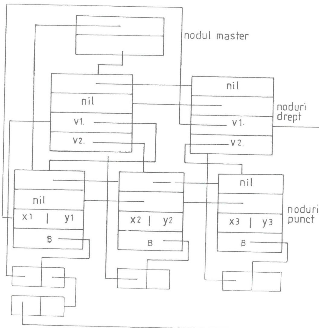
**Figura 1.**Noduri master înlăntuite în structură de inel
