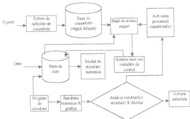
**Figura 8. Diagrama sistemului de simulare hibridă, bazată pe cunoștințe – adaptare după [19]**
