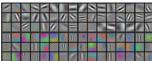
Figura 12. Nucleele/filtrele convoluționale învățate în primul strat convoluțional pe cele două „fire” de procesare paralelă pe câte unul dintre cele două GPU (Sursa: Krizhevsky, 2012 [29])
